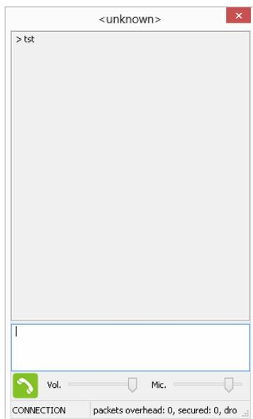
В строке состояния отображается текущее состояние соединения и количество посланных, принятых зашифрованных пакетов, отклоненных пакетов и пакетов для установки соединения.
